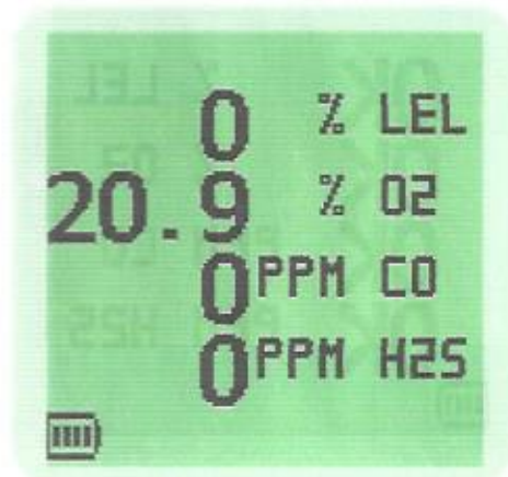
Fig. 1-2 Display Example (4-Gas)
